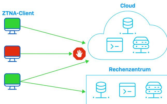
Zudem ist ZTNA insgesamt dynamischer und transparenter, läuft im Hintergrund und erfordert – von der ersten Identitätsprüfung abgesehen – keinerlei Benutzerzugriff. Ihre Benutzer bemerken meist nicht einmal, dass sie sich über sichere, verschlüsselte Tunnel mit Anwendungen verbinden.
