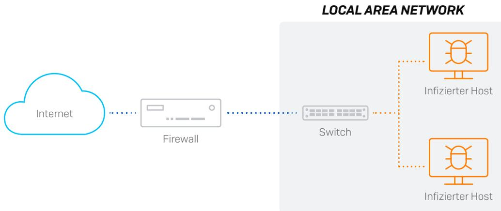
Eine Best Practice ist es, das LAN unter Verwendung von Zonen und VLANs in kleinere Subnetze zu segmentieren und diese dann durch die Firewall miteinander zu verbinden. So wird eine Anwendung von Anti-Malware- und IPS-Schutz zwischen Segmenten ermöglicht. Auf diese Weise können Bedrohungen effektiv identifiziert und blockiert werden, die versuchen, sich lateral im Netzwerk zu bewegen.
