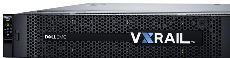
▲ **Dell EMC VxRail:** Dank vSphere-/vSAN-Unterstützung lassen sich die hyperkonvergenten Appliances komplett über VMware vCenter steuern. (Foto: Dell)
